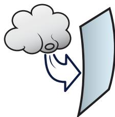
Indica la capacità dell'infisso di resistere alla pressione esercitata dal vento ad una determinata velocità.
