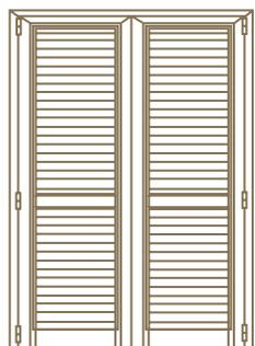
La persiana con telaio, a differenza di quella rustica che è ancorata direttamente al muro, è costituita, appunto, da un telaio su cui sono poggiate le ante. Le numerose varianti di linee estetiche consentono di scegliere il design più adatto al proprio gusto personale e all'architettura dell'edificio. Questa tipologia di persiana può montare sia lamelle fisse che orientabili, a seconda dell'impostazione che si intende dare al passaggio di luce/aria da e verso l'esterno.
