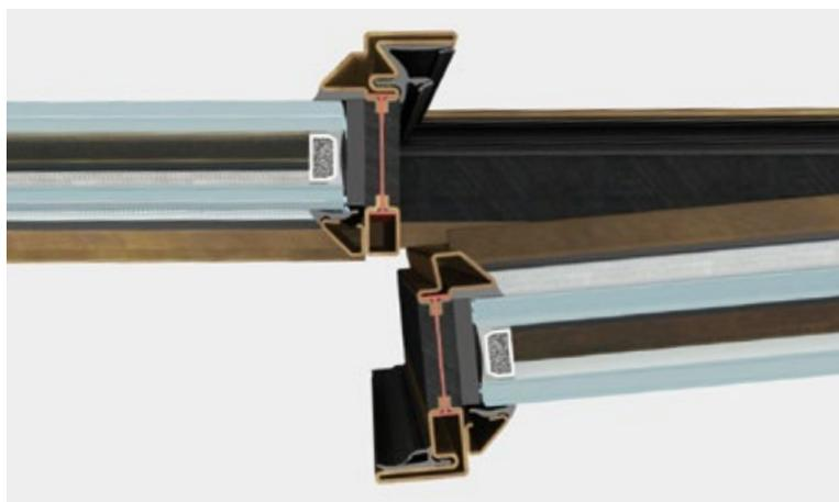
Le caratteristiche di tenuta dei serramenti sono garantite da un sistema a giunto aperto con una guarnizione centrale di tenuta e una interna di battuta. Le prestazioni del sistema a taglio termico BV sono state testate dai migliori laboratori di certificazione europei secondo le norme di riferimento EN 14351-1.
