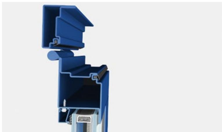
SA 20 porta è un sistema integrato di accessori, guarnizioni e profilati non isolati termicamente aventi profondità di 60 mm che consente di realizzare un'ampia gamma di porte, rettangolari, sagomate o curve. Si possono installare vetri a doppia camera fino a 40 mm di spessore. Le caratteristiche di tenuta dei serramenti sono garantite da un sistema a doppia guarnizione di battuta su tre lati e da una guarnizione a ghigliottina automatica sottozoccolo.
