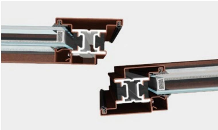
Le caratteristiche di tenuta dei serramenti sono garantite da un sistema a doppia guarnizione di battuta su tre lati e da una guarnizione a ghigliottina automatica sottozoccolo. Ogni tipologia è provvista di apposita accessoristica (anche a scomparsa) integrata. Le prestazioni del sistema a taglio termico EBE 65 sono state testate dai migliori laboratori di certificazione europei secondo le norme di riferimento EN 14351-1.
