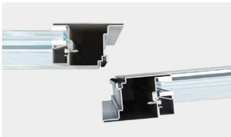
La capacità del serramento di non far passare le fiamme e i fumi caldi (tenuta al fuoco E) è garantita dalla strutturale del profilo e dal sistema a doppia guarnizione di battuta; la capacità di contenere l'irraggiamento dal lato non esposto alle fiamme (irraggiamento W) è ottenuta grazie agli speciali vetri installati. Le prestazioni del sistema SA AF sono state testate dai migliori laboratori di certificazione europei secondo le norme di riferimento EN 1634-1.
