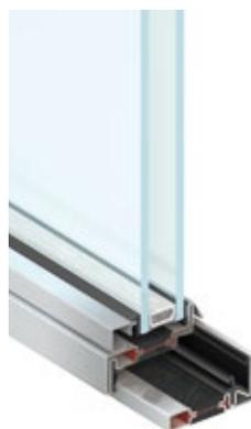
Ferrofinestra a taglio termico per vetri fino a 40 mm, profili da 27 mm, nodo centrale 62 mm
