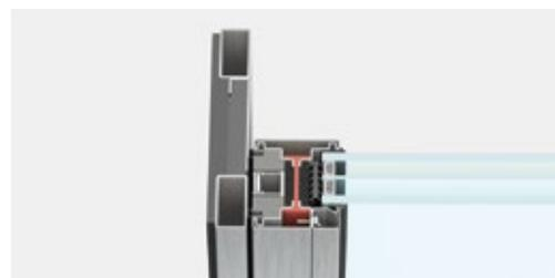
nodo centrale standard | sezione in vista 94 mm
