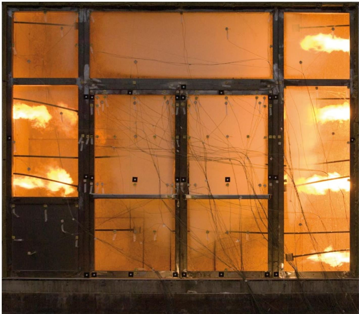
La capacità di un infisso di resistere alle grandissime sollecitazioni causate da un incendio viene testata in appositi laboratori provvisti di speciali forni e strumentazioni secondo delle procedure strettamente normate dalla comunità europea. Il test si esegue su un campione costruito in scala reale nel quale tutti
