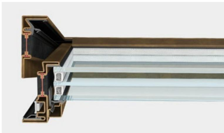
OS2 finestra apertura interna è un sistema integrato di accessori, guarnizioni e profilati a taglio termico con profondità di 77 mm che permette di realizzare un'ampia gamma di finestre, rettangolari, sagomate o curve. Si possono installare vetri camera fino a 50 mm di spessore. Il sistema prevede la possibilità di avere l'apertura ad anta ribalta.
