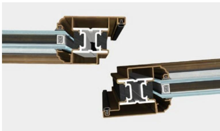
Le caratteristiche di tenuta dei serramenti sono garantite da un sistema a doppia guarnizione di battuta su tre lati e da una guarnizione a ghigliottina automatica sottozoccolo. Ogni tipologia è provvista di apposita accessoristica (anche a scomparsa) integrata. Le prestazioni del sistema a taglio termico ST 65 sono state testate dai migliori laboratori di certificazione europei secondo le norme di riferimento EN 14351-1.
