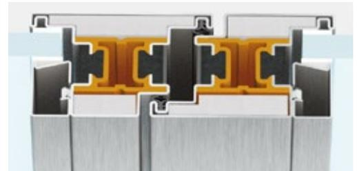
nodo centrale | sezione in vista 156 mm
