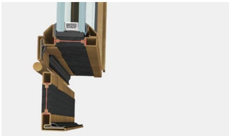
BV porta apertura esterna è un sistema integrato di accessori, guarnizioni e profilati a taglio termico con profondità di 77 mm che permette di realizzare un'ampia gamma di porte, rettangolari, sagomate o curve. Si possono installare vetri camera fino a 32 mm di spessore. Le caratteristiche di tenuta dei serramenti sono garantite da un sistema a doppia guarnizione di battuta e da una guarnizione a ghigliottina automatica sotto zoccolo.
