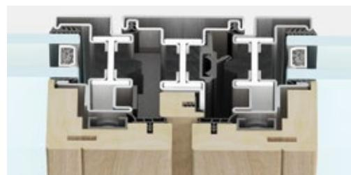
nodo centrale | sezione in vista 145 mm
