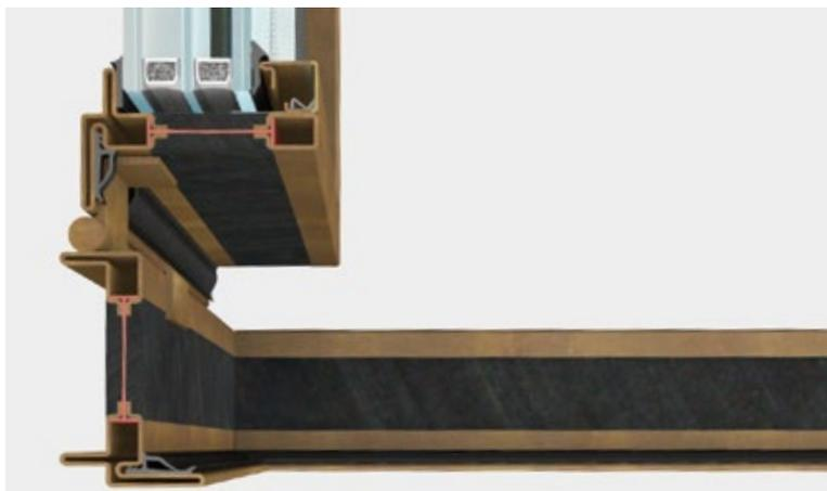
OS2 finestra apertura esterna è un sistema integrato di accessori, guarnizioni e profilati a taglio termico con profondità di 77 mm che permette di realizzare un'ampia gamma di finestre, rettangolari, sagomate o curve. Si possono installare vetri camera fino a 50 mm di spessore. Ogni tipologia è provvista di apposita accessoristica integrata al sistema.
