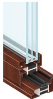
Sistema EBE a taglio termico, profondità 75 mm per vetri fino a 48 mm, complanarità esterna ed interna tra anta e telaio
