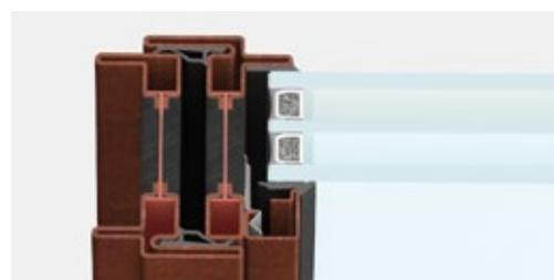
nodo laterale inferiore | sezione in vista 62 mm
