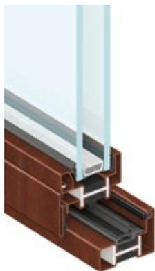
Sistema EBE a taglio termico, profondità 65 mm per vetri fino a 48 mm, sormonto interno e complanarità esterna tra anta e telaio
