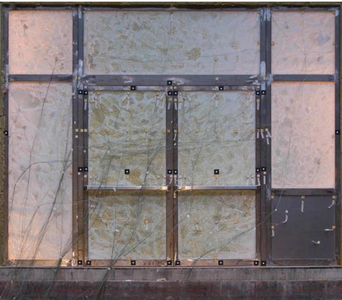
Sul campione vengono applicati numerosi sensori e rilevatori che consentono di valutare la conformità dell'elemento alle specifiche di classificazione. Sono misurate e valutate non solo le temperature che si presentano sulla faccia "fredda" del campione, ma anche le deformazioni che si presentano lungo il procedere della
