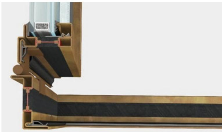
OS2 finestra apertura esterna è un sistema integrato di accessori, guarnizioni e profilati a taglio termico con profondità di 65 mm che permette di realizzare un'ampia gamma di finestre, rettangolari, sagomate o curve. Si possono installare vetri camera fino a 32 mm di spessore. Ogni tipologia è provvista di apposita accessoristica integrata al sistema.
