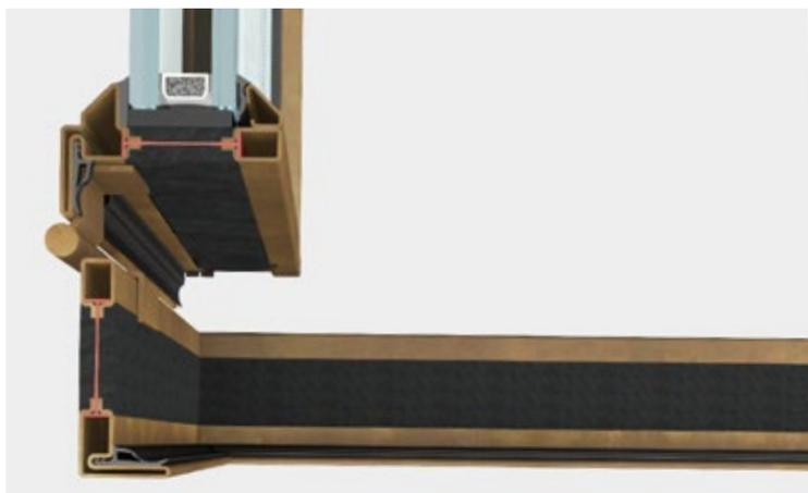
BV finestra apertura esterna è un sistema integrato di accessori, guarnizioni e profilati a taglio termico con profondità di 77 mm che permette di realizzare un'ampia gamma di finestre, rettangolari, sagomate o curve. Si possono installare vetri camera fino a 32 mm di spessore. Ogni tipologia è provvista di apposita accessoristica integrata al sistema.
