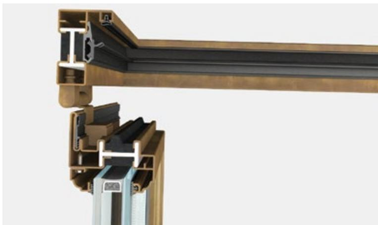
ST 65 finestra è un sistema integrato di accessori, guarnizioni e profilati a taglio termico disponibile nelle versioni 65, 75 e 85. ST 65 consente di realizzare un'ampia gamma di finestre, rettangolari, sagomate o curve e di installare vetri isolati fino a 52 mm di spessore. Ogni tipologia è provvista di apposita accessoristica (anche a scomparsa) integrata al sistema.
