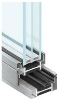
Sistema EBE a taglio termico, profondità 85 mm per vetri fino a 68 mm, sormonto interno e complanarità esterna tra anta e telaio
