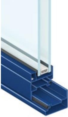
Sistema di profili tubolari con spessore delle lamiere 2 mm, profondità 60 mm per vetri fino a 48 mm, complanarità esterna e interna tra anta e telaio
